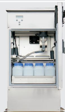
WS 312 mit Unterbau 12 x 2,9 l
